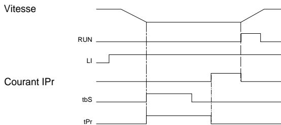
Le préchauffage est établi lorsque l'entrée est sous tension et que le moteur est arrêté, après que les temporisations TPR (W4046) et TBS (W4032) soient écoulées. Le préchauffage s'arrête si l'entrée est désactivée, ou si un ordre de marche est donné, ou si l'entrée STOP est actionnée.
